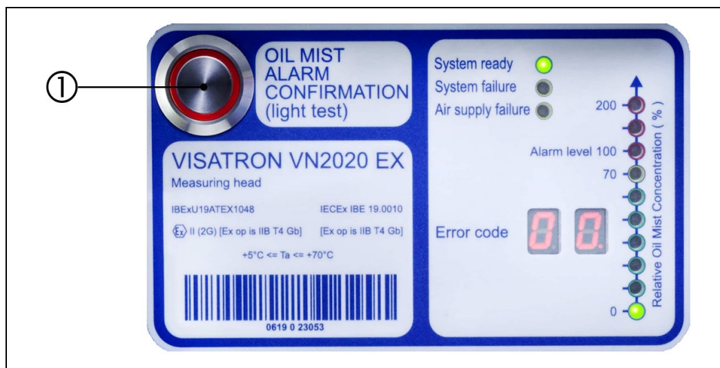
Зобр.: 66 : Вимірювальний блок VN2020: Перевірка світлодіодів (тестування індикаторів)
