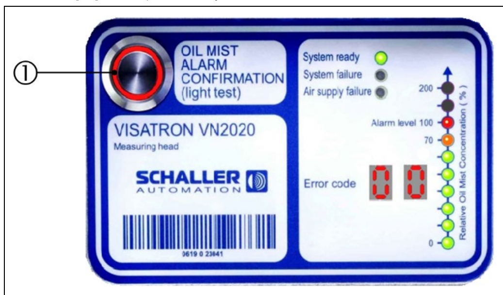
Зобр.: 69 : Вимірювальний блок VN2020: Підтвердження тривоги по масляному туману
